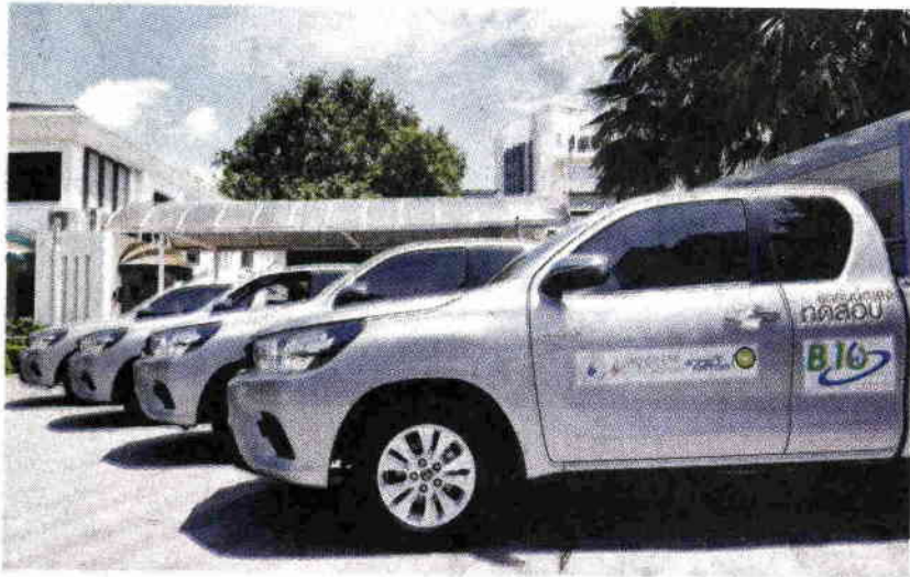
กระบะเครื่องยนต์ดีเซลในการทดสอบใช้ B10 ซึ่งได้จากการพัฒนาต่อยอดไบโอดีเซลคุณภาพสูง เอช-เฟม
